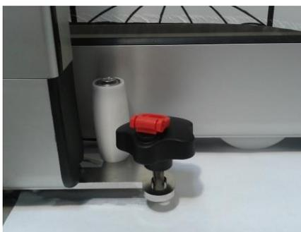
Vérifier le positionnement des éléments. Dans le cas où tous les 2 côtés sont en ordre, marquer les points de fixation selon la photo sur le sol. Veiller à ce que le point de forage sera au milieu du trou de la patte.
