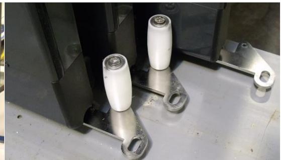
Les éléments une fois enclenchés, boulonner les butées caoutchouc dans la position pré-forée du rail de guidage.(Fixer les butées caoutchouc dans la bonne position afin que l'eau s'écoule sans obstacle)!
